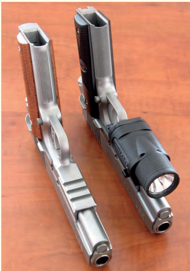
GSR 1911 a GSR 1911 Revolution mají před lučičkem lištu pro uchycení taktických doplňků. Viditelné jsou rozdíl ve zdrsnění čel rukojeti a rozšířená dna zásobníkových šachet dovolující rychlou výměnu zásobníku.
