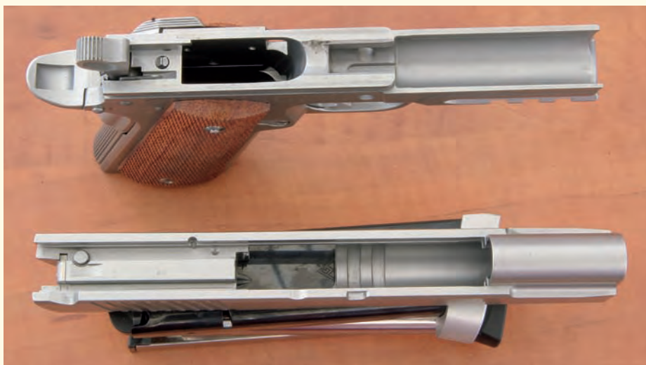
Pistole Sigarms GSR 1911 rozložena na základní součásti k čištění
