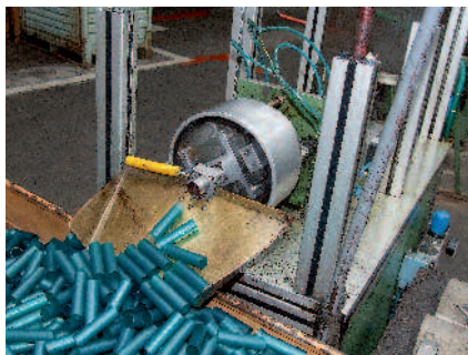
◀ Zvenku vypadá jednoduše, ale ve válci na konci linky je několik nastavitelných nožů, které řezou trubku na přesnou délku a srážejí hrany řezů
