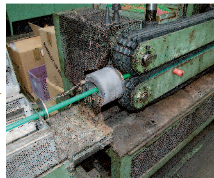
◀ V dalším úseku stroje se trubka suší a průchodem přes disk s otvorem ve tvaru mnohohorné hvězdice se povrch drážkuje. Drážkování podstatně ulehčuje vyhození vystřelené nábojnice z komory.
