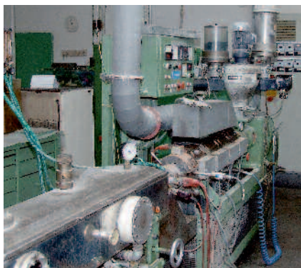
◀ Výroba brokových nábojů dnes začíná u tavicí pece. Polyetylenový granulát se zahřívá, míchá s barvivem a protlačuje tryskou, která dává taženině podobu trubky.
