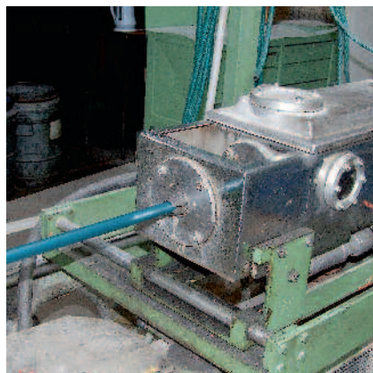
◀ V lázni s kontrolovanou teplotou dostává materiál trubky požadované vlastnosti
