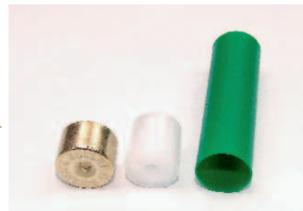
◀ Hlavní části brokové nábojnice: polotovaz kování dna, na kterém zatím není vytvářen vystupující okraj a lůžko pro zápalku je jenom naznačeno, plastové dno nábojnice a dutinka
