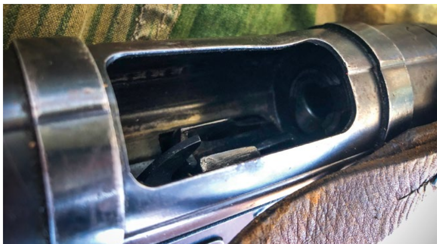
Nábojiště s otevřeným závěrem. Deformace plechu kolem výhozného okénka je dost typická, ale nebrání volnému pohybu závěru.
