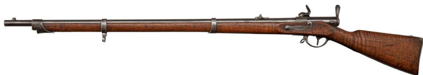
Perkusní zadovka Podewils-Lindner z Vlastivědného muzea v Olomouci. Při transformaci perkusní předovky M1858 na systém Podewils-Lindner se snažili vyměnit nebo pozměnit jen ty díly, u nichž to bylo nezbytně nutné. Přibyl válcový odsuvný závěr, jehož klika by při uzamčení měla směřovat doprava, a zámková deska sahá u transformované zbraně výš než u původní. Pažba za hlavní byla vydlabána, aby se do vzniklého prostoru vešlo válcové pouzdro závěru.
