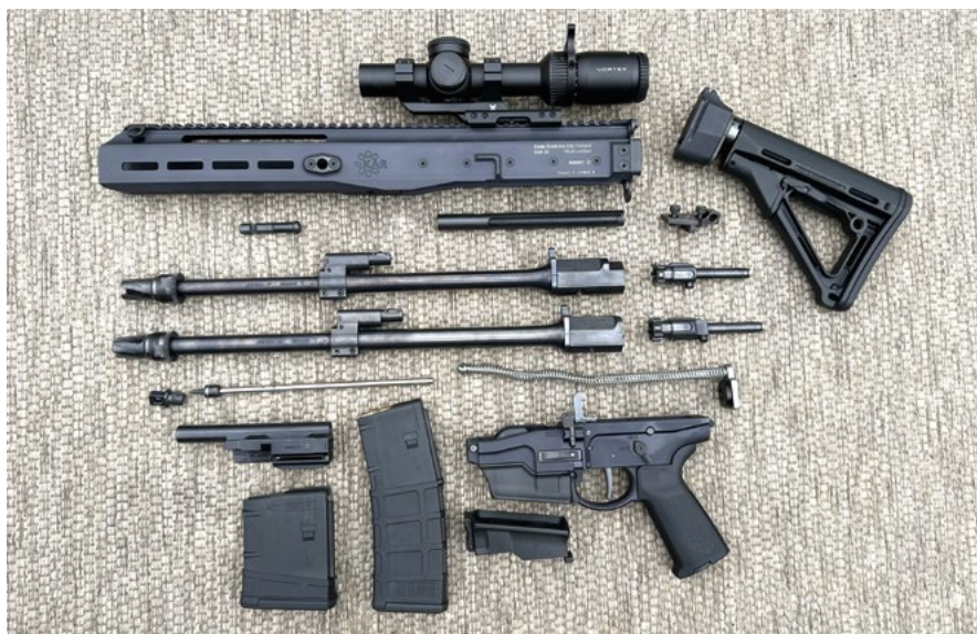
KAR-21 rozebraná na čištění a včetně konverzní sady. Jsou zde dvě 16" hlavně, dva závorníky, dvě zásobníkové šachty. Pod horním rámem leží vpravo napínací páka a vlevo perforovaná trubice, která přenáší sílu z páky na nosič závěru. Vedle ní pod pažbou je recoil block se dvěma šrouby.
