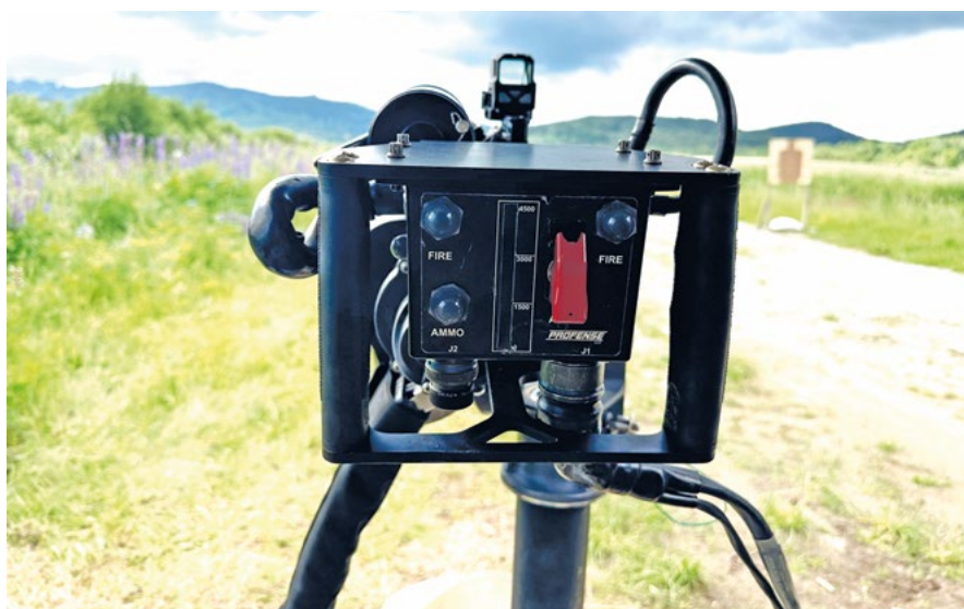
Ovládací panel je poměrně strohý. Před stisknutím spouště je nutné přepnout pojistku pod červeným krytem.
