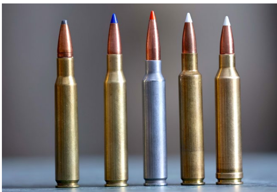
Zleva náboje 30-06 Springfield, 280 Remington, 7 mm Backcountry, 280 Ackley Improved a 7 mm Remington Magnum. Kromě 7 mm Backcountry všechny vycházejí z nábojnice 30-06, 7 mm Rem Mag má navíc nákrůžek už tak poměrně tlustého dna.
