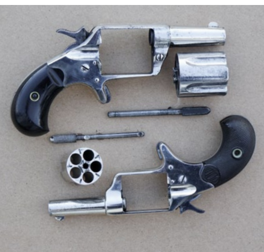
Revolvery s vyjmutými válci. U exempláře ráže .32 jsou na válci vidět vybrání mezi komorami, do kterých zapadá aretační páka.
