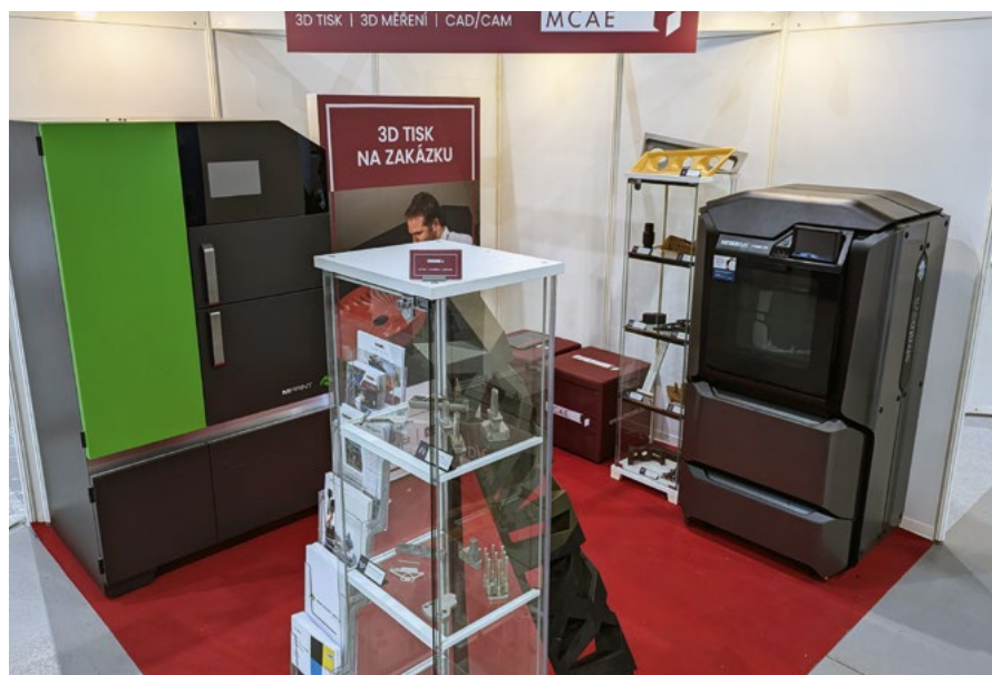
Na výstavě Future Forces, Praha 2024. Vlevo laserová 3D tiskárna kovů MPrint od One Click Metal, vpravo 3D tiskárna plastů a kompozitů F190 CR od Stratasysu.
