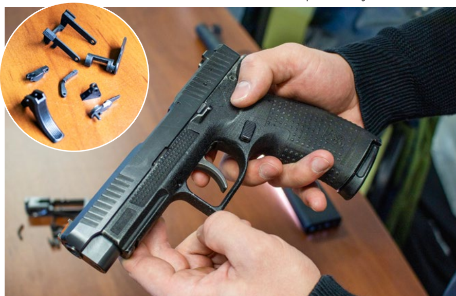
Pistole s instalovanými díly z 3D tiskárny. Protože jde převážně o díly spouštěcího mechanismu, většina jich není na první pohled vidět.
