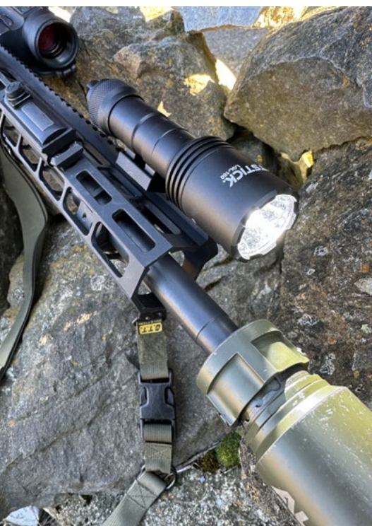
Nightstick LGL-160 na pušce AR-15. Na boční liště je nacvaknutý držák vzdáleného spínače.
